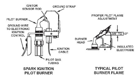
FIGURE 22. SPARK IGNITION PILOT BURNER AND BURNER FLAME
