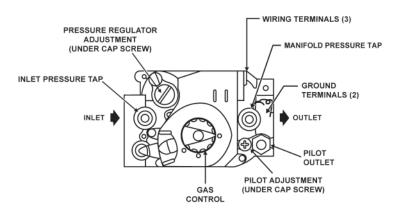
FIGURE 17. GAS CONTROL VALVE (NATURAL GAS & PROPANE)
